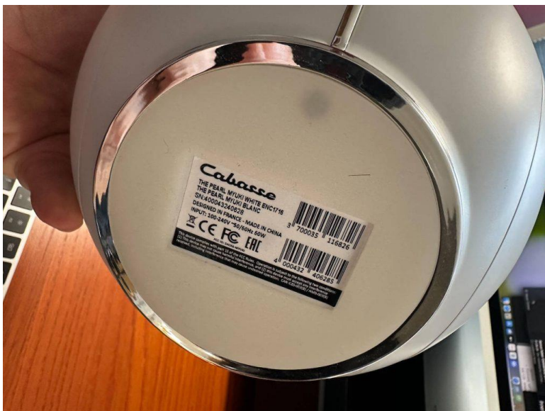
Die Unterseite mit Silikonbeschichtung. Unter dem Aufkleber befindet sich ein Gewinde für Standfüße oder Wandhalterungen (Foto: F. Borowski)
