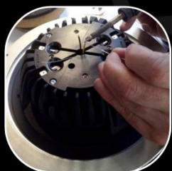
Etape 14 Intégration du Haut-Medium /Aigu avec le Bas-Mediums
