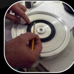
Etape 15 Collage suspension avant centrale
