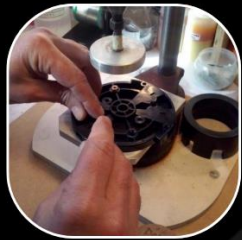
Etape 13 Préparation de l'interface à cosses
